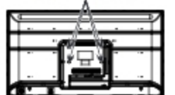
PLD 43AG9953, PLD 43BAG9953 LUBANG SEKRUP UNTUK WALL MOUNTING (UKURAN LUBANG SEKRUP M6x10)
